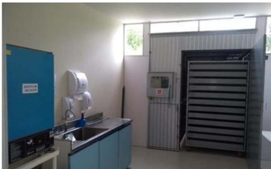
Foto 24- Estufa de secagem de matéria prima vegetal
